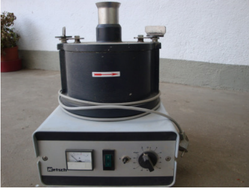
Retsch Labor-Zentrifugalmühle ZM 1 mit verschiedenen Ringsiebe
