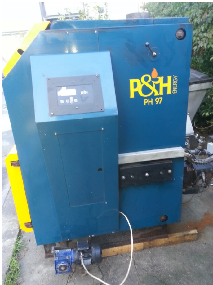
P&H Biobrennstoffkessel , Heizung Typ PH97, BJ 2008, 97 KW für den Einsatz für alle Biomasse-Produkte wie Holzpellets, Getreide, Raps, Dinkelspelz usw.
